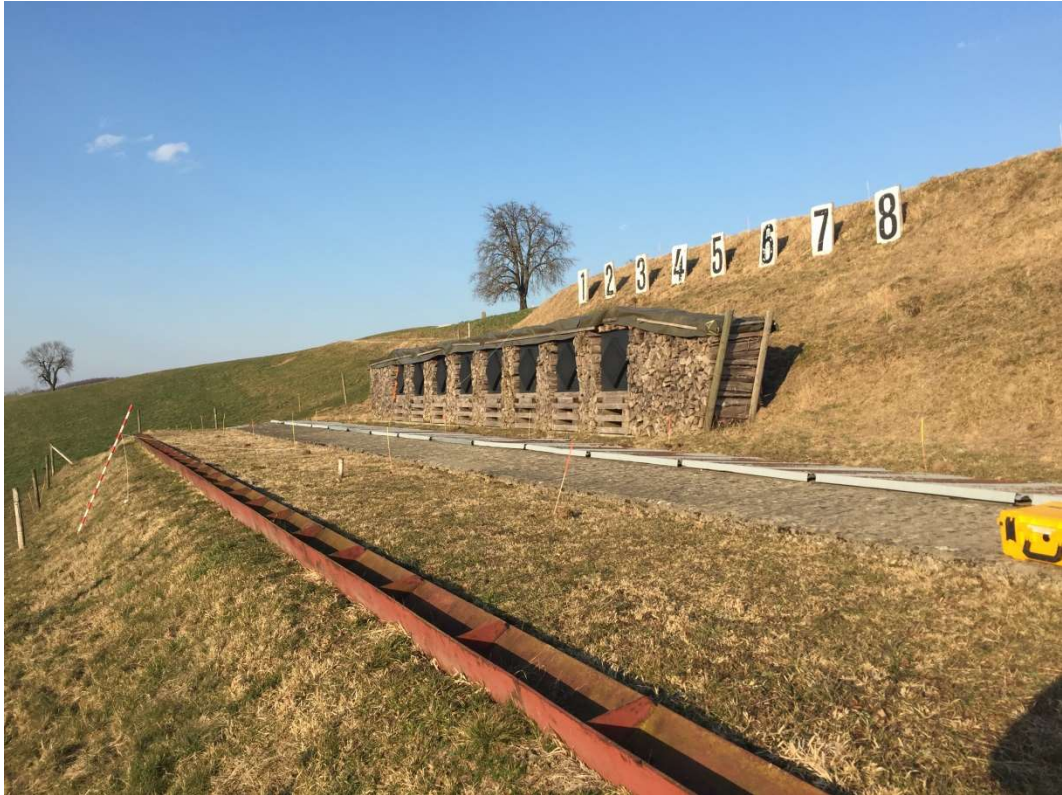
Nr. 4: Absteckung der Messpunkte für XRF-Messung über das gesamte Kugelfangareal. (Porta AG, 28.02.2019)
